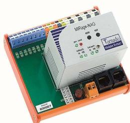
Модуль MIRage-NAO предназначен для формирования аналоговых сигналов напряжения или тока по 4-м независимым каналам. Сигналы формируются под управлением команд, передаваемых по дублированной цифровой линии связи Ethernet 10/100 с использованием протокола ModBus.
