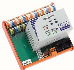
Модуль MIRage-NPT предназначен для измерения температур с помощью датчиков термометров сопротивления различных градиуровок (термосопротивлений) и передачи измеренных значений через дублированный цифровой интерфейс Ethernet 10/100 по витой паре.
