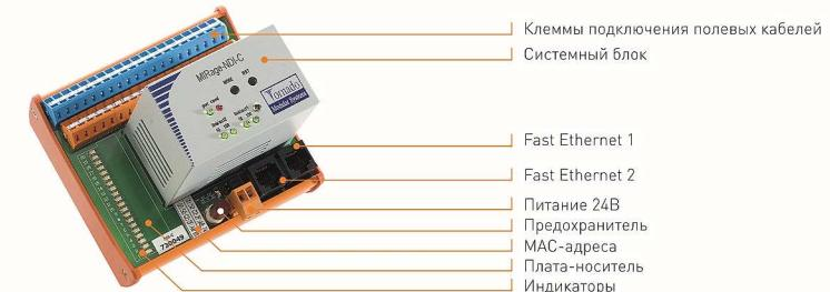
На некоторых модулях [MIRage-NAI, MIRage-NDIO] установлены съёмные полевые вставки нормирующих преобразователей и индивидуальных гальванических развязок, выполняющие функции промежуточных реле, источников питания аналоговых датчиков и т.п.
