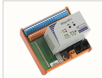
Модуль MIRage-NDI-C предназначен для ввода дискретных сигналов от датчиков типа «сухой контакт» при построении распределённых информационных и управляющих систем. Чтение состояний сигналов дискретных вводов производится через дублированный цифровой интерфейс Ethernet 10/100 по витой паре с использованием протокола ModBus.
