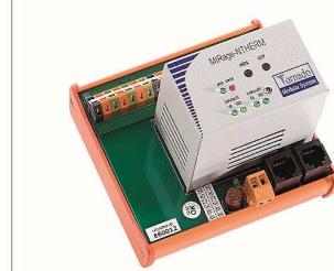
Модуль MIRage-NTHERM предназначен для измерения температур с помощью термопар и передачи измеренных значений через дублированный цифровой интерфейс Ethernet 10/100 по витой паре с использованием протокола ModBus.
